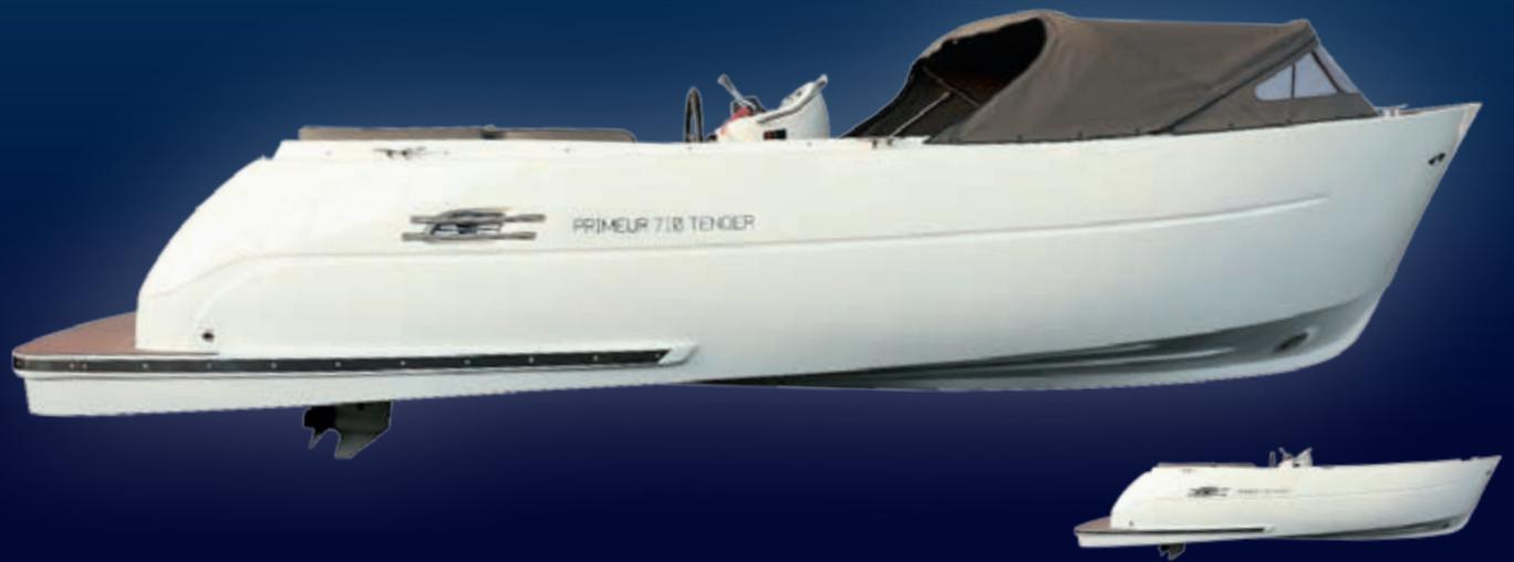
**Die Primeur 710 ist die neueste Ergänzung die Primeur-Linie und wird von einem Außenbordmotor angetrieben, der in einem geräuschisolierenden Motorschacht angebracht werden kann.**
